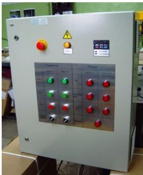
*Элементная база станции:* преобразователь частоты Delta со встроенным контроллером и платой расширения, коммутационное и защитное оборудование Dekraft, оборудование для управления и сигнализации Dekraft, реле цепей управления IEK, блок питания цепей управления Delta, оборудование для принудительной вентиляции Fandis, корпус шкафа станции управления IEK.
